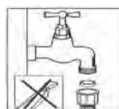
réducteur de pression entre le robinet et le tuyau. Une fois les raccords effectués, ouvrez le robinet à fond et vérifiez l'étanchéité. Pour la sécurité de votre appareil, prenez soin de toujours fermer le robinet d'arrivée d'eau après la fin de chaque programme.
