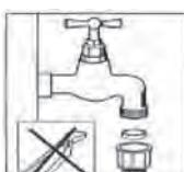
dem Wasserhahn und dem Schlauch installiert werden. Nach dem Anschließen, drehen Sie den Wasserhahn vollständig auf, um die Dichtigkeit zu prüfen. Aus Sicherheitsgründen des Geräts, sollten Sie immer am Ende des jeweiligen Programms den Wasserhahn der Wasserversorgung zudrehen.
